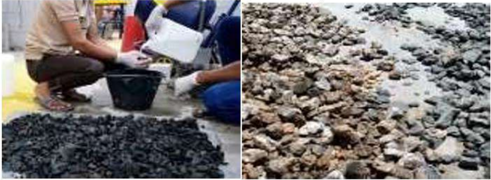
شكل (5) يوضح طريقة غسل وتجفيف وتحضير عينات الركام المعاد تدويره
