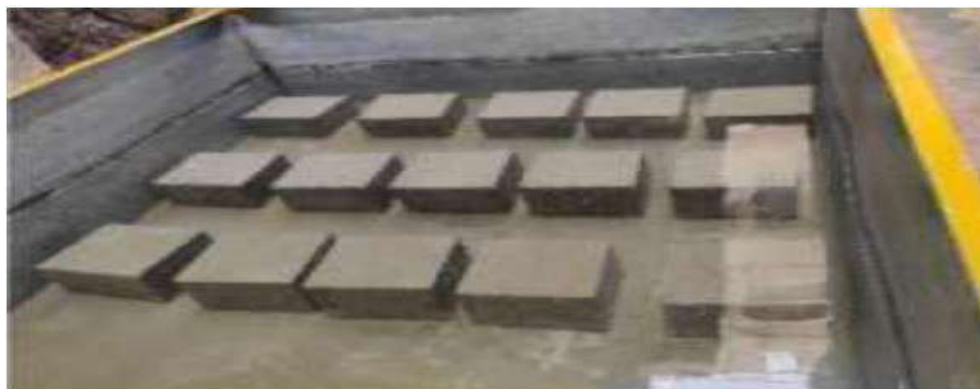
شكل (9) الحوض المائي المستخدم لغمر المكعبات
