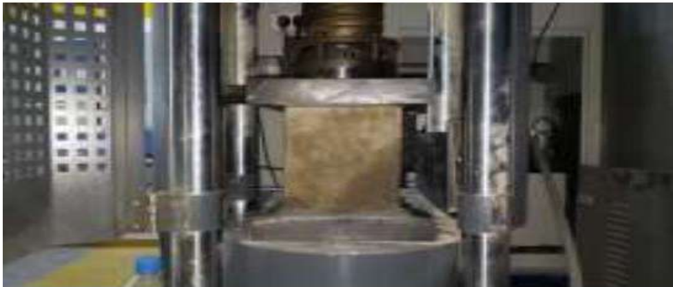
شكل (8) اختبار مقاومة الضغط للمكعب الخرساني
